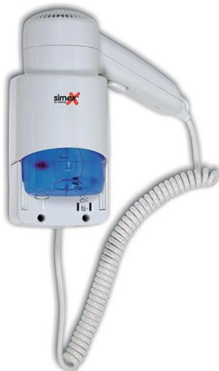
Sèche-cheveux mural économique avec prise rasoir sur la base. Prise européenne et américaine. Bouton de sécurité on/off sur le manche. Fabriqué en ABS blanc. Deux vitesses réglables : puissance 540 ou 1200 W. Moteur puissance 40 W. Niveau sonore 60 db. Vitesse d'air : 20 m/s. Voltage 220-240 V, fréquence 50/60 Hz. Classe II. Norme CE. Dims (cm) : L 9,2 X P 11,5 X H 20,5. Poids : 1,3 kg.
