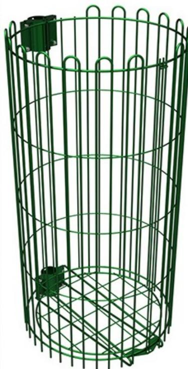
Grille en partie inférieure pour maintien du sac. Couronne réglable en hauteur. Large ouverture frontale pour retrait des sacs pleins sans difficulté. Verrouillage manuel. Fixations sur poteau fournies. Acier peinture Vert RAL6005. Autres coloris, nous consulter. Attention : fixation uniquement sur poteau Ht 1,20 mètre. Poids : 7 Kg
