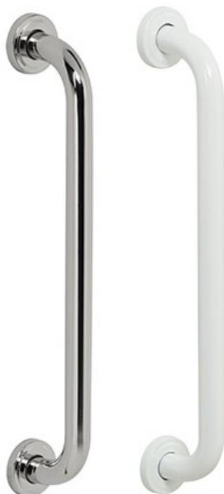
Barre de relèvement pour répondre aux obligations dans le domaine de l'accessibilité et de l'autonomie. Fabriquée en tube inox Ø 25 mm. Deux finitions au choix, à préciser à la commande : blanc ou chromé. Poids supporté 150 kg. Dims : L 44,5 X P 8 X H 5,5
