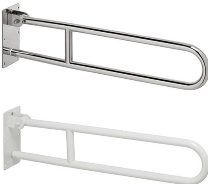
Barre de relèvement pour répondre aux obligations dans le domaine de l'accessibilité et de l'autonomie. Fabriquée en tube inox Ø 25 mm. Deux finitions au choix, à préciser à la commande : blanc ou chromé. Poids supporté 120 kg. Dims : L 70 X P 10 X H 20,2.
