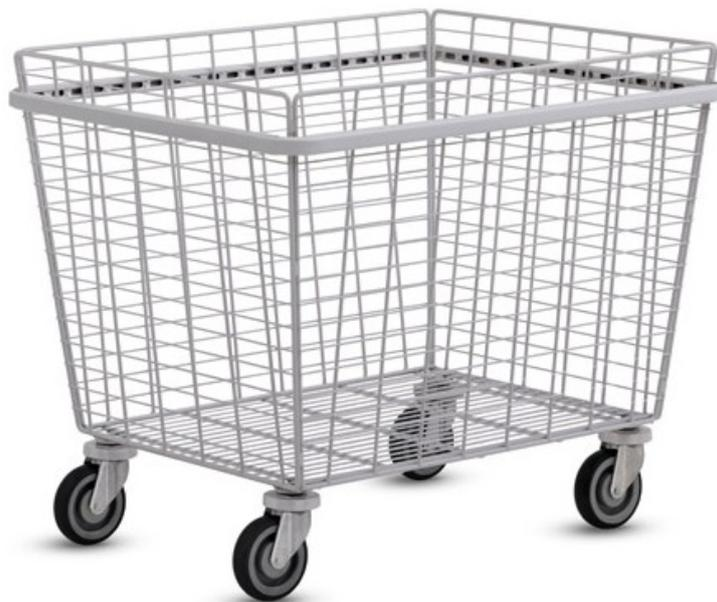
Panier en fil à maille étroites avec profilé périphérique en caoutchouc blanc faisant office de pare-chocs. Revêtement de surface : Thermolaqué de couleur blanc Roues : 4 roues pivotantes avec bagues déflectrices en plastique et bande de roulement en caoutchouc.
