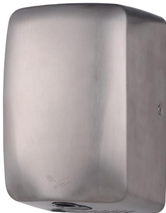
Sèche-mains anti-vandalisme. Capot en acier inoxydable AISI 304. Finition inox satiné. Séchage rapide. Temps de séchage : 10 à 15 secondes. Vitesse d'air en sortie : 215 à 380 km/h. Débit sonore limité : 65 à 72 dB. Moteur monobloc à balais. Chauffage auto-régulé < 40°C. Consommation électrique 500 à 1150 W. Tension d'alimentation 220-240V. Protection électrique : IPx1 Classe I. Aucun entretien nécessaire. Dims (cm) : L18 x P15,2 x H26. Poids : 3 kg.
