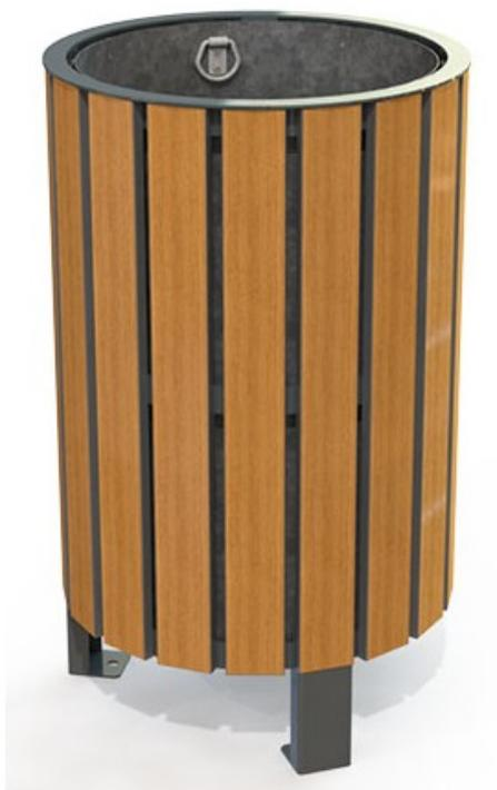
Corbeille moderne avec une belle finition. Structure en tôle d'acier électrozingué ép. 3 mm, Finition thermolaquée, coloris au choix selon RAL. Habillage en lames de stratifié compact ép. 14 mm. Finition aspect teck. Bac intérieur en tôle d'acier galvanisé. Fixation au sol sur sol béton par chevillage. Volume 60 L. Dims (cm) : diamètre 43,5 x H71,9. Poids : 23,5 kg.
