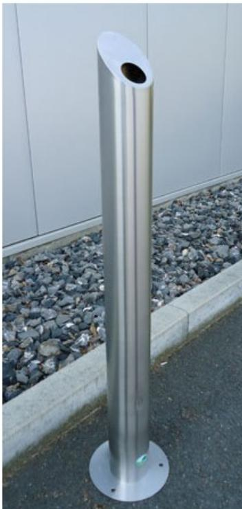
Superbe cendrier colonne en inox. Au choix : inox mat ou poli. Accès facile à l'insert de récupération des cendres et des mégots avec verrouillage par clé. Insert en tôle d'acier. Pied platine à poser ou à sceller (3 trou dans la platine). Dims (cm) : diamètre 10 X H100. Platine diamètre 20 cm. Ouverture diamètre 4 cm. Poids : 8,5 kg.
