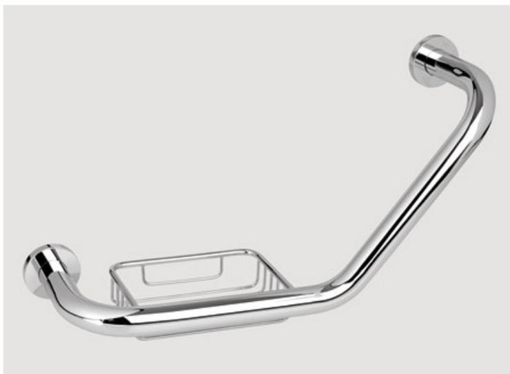
Barre murale de maintien avec porte savon. Barre : tube de laiton chromé de Ø 25 mm et 0,8 mm d'épaisseur. Porte-savon : tube de laiton chromé de Ø 2,5 mm. Fixation murale grâce à 2 points d'ancrage. Réversible. Dims (en cm) : P12,5 X L45,5 (de fixation à fixation), angle à 120°. Quantité minimum : 3.
