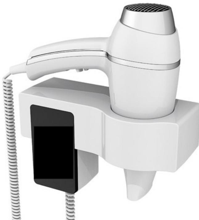
Un sèche-cheveux moderne et performant. Puissance 1800 W. Mise en marche par simple prise en main. Concentrateur amovible et orientable. 6 configurations de séchage : débit d'air 70 et 115 m<sup>3</sup> h et 3 températures dont 1 froide. Equipé d'un ioniseur. IP 21. Installation dans le volume 3. Classe II. Dims (cm) : L 22,7 X P 10 X H 25,8. Coloris blanc. Dim cable 35 cm.
