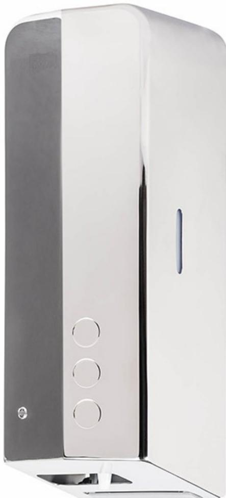
Distributeur de savon liquide ou gel hydroalcoolique automatique conçu pour les espaces publics à haute fréquence d'utilisation. Boîtier en inox AISI 304, finition chromé brillant. Capteur infrarouge électronique qui arrête le distributeur dès que les mains sont retirées du champ de détection. Fonctionne avec 6 piles de 1,5 V. Fenêtre de contrôle de niveau. Verrou de sécurité. Contenance 1000 ml. Dim (cm) : L10,5 x P9,5 x H27,5.
