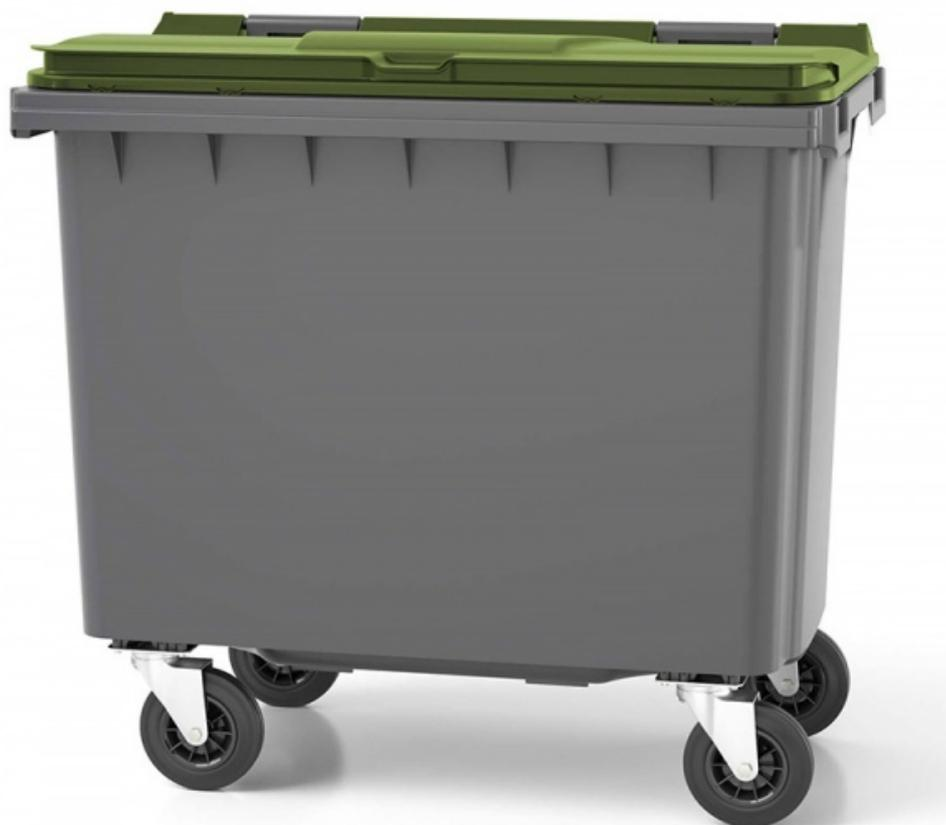
Bac roulant 660 L fabriqué en PEHD injecté. Norme EN 840. Préhension frontale. Equipé de 4 roues diamètre 160 mm avec bandage caoutchouc. Corps gris. Coloris de couvercle au choix : rouge, vert, gris anthracite, bleu, jaune, marron. Dims (cm) : 126,8 x 79,7 x H120,2. Poids : 38 kg.
