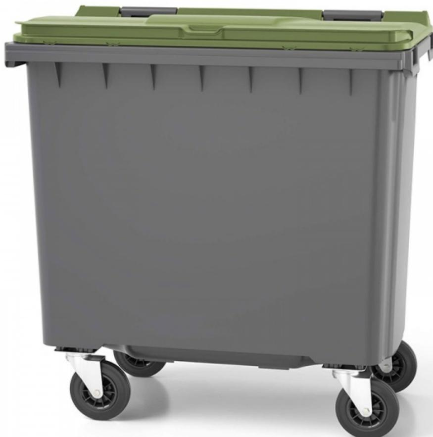
Bac roulant 660 L fabriqué en PEHD injecté. Norme EN 840. Préhension frontale. Equipé de 4 roues diamètre 160 mm avec bandage caoutchouc. Corps gris. Coloris de couvercle au choix : rouge, vert, gris anthracite, bleu, jaune, marron. Dims (cm) : 126,8 x 79,7 x H130,2. Poids : 39,5 kg.
