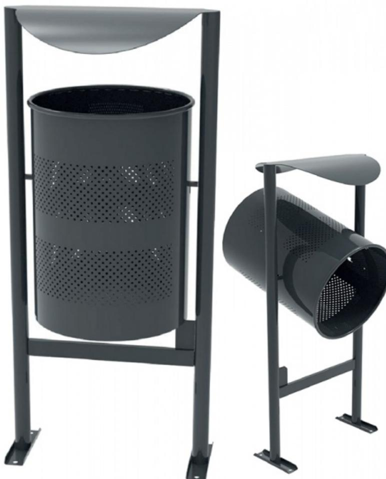
Corbeille basculante avec toit de protection pratique et économique. Fabriquée en tôle d'acier perforé et galvanisé. Finition peinture époxy gris RAL 7011. Ancrage par vis M10 X 100 mm (non fournies). Volume 60 L. Dims (cm) : L 48,7 X P 42 X H 108,4. Poids : 9,3 kg.
