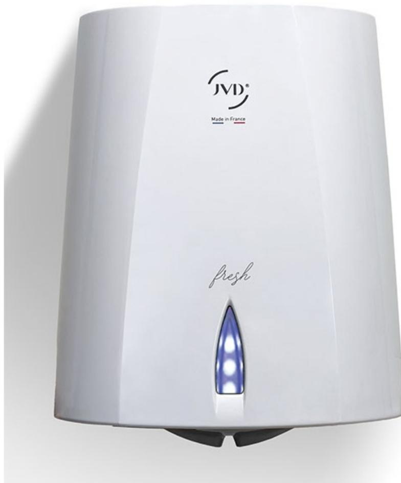
Le sèche-mains qui neutralise les mauvaises odeurs sans consommable = pas d'utilisation de parfum de synthèse. Idéal pour les zone de fort passage. Capot anti-vandalisme en ABS IK9 avec 25% de plastique recyclé. Coloris blanc. Eclairage de la zone de séchage. Puissance nominale : 600 W. Faible consommation électrique. Niveau sonore : 75 dB. Alimentation 220-240 V / 50 Hz. Classe II. IP 24. Dims (cm) : L21,6 x P19,5 x H29,2. Garantie 2 ans. Fabrication Française.
