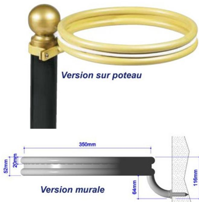
Une gamme de porte sacs très robuste idéale à proximité des passages protégés, des arrêts de bus, des sorties de gares? Indispensables dans le cadre du plan Vigipirate. Ces porte sacs sont traités anti-corrosion, en acier galvanisé à chaud (+, - 80 microns), leur apportant une protection remarquable. La coloration est obtenue par thermolaquage (poudre polyester cuite au four), isolant et décoratif. 7 coloris au choix. Diamètre de l'anneau 350 mm. Anneau hauteur 52 mm.
