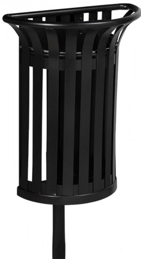
Conception anti-vandalisme. Fabriquée en acier. Couche de protection primaire anticorrosion. Finition peinture polyester haute résistance. 4 coloris au choix : vert mousse 6005, vert olive 6003, gris manganèse, anthracite mat 7016. Support sac intérieur pour faciliter la mise en place du sac. Fond perforé pour l'évacuation des eaux de pluie. Modèle demi-lune fixation sur poteau. Volume 35 L. Permet de mettre un sac de 50 L. Dims (cm) : L 54,5 X P 31 X H 73,5. Poids : 8,5 kg.
