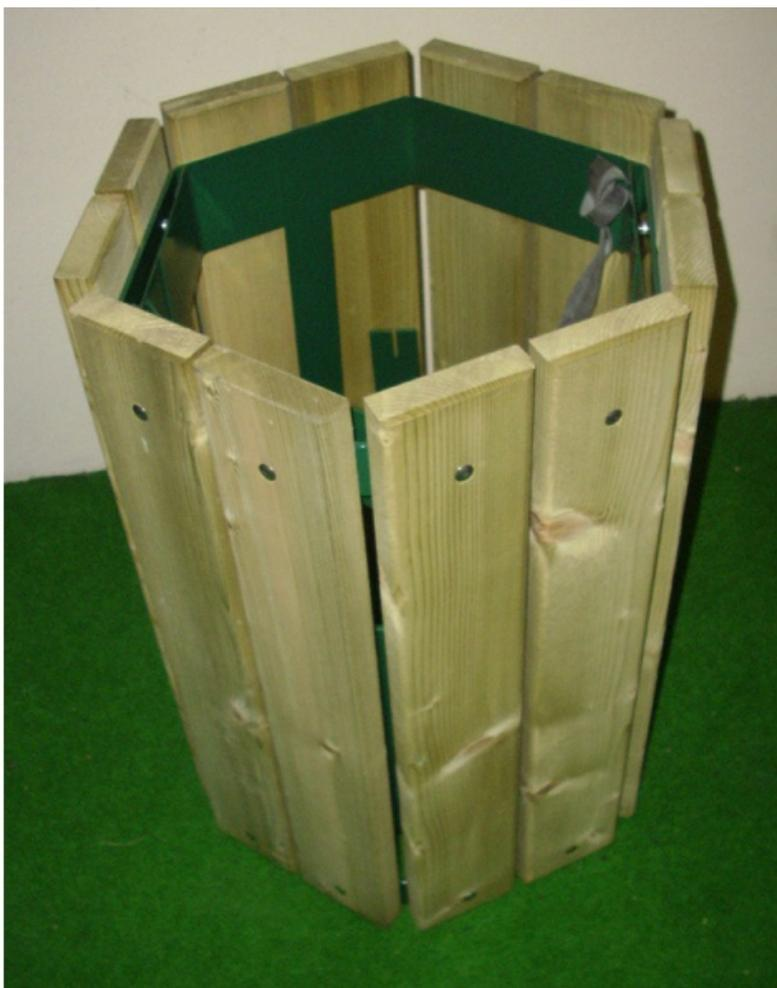
Fabriquée en France, stock permanent. Corbeille de propreté hexagonale, à sceller. Ses plus : pas d'angle vif pour plus de sécurité, livrée montée. Armature et porte sac en acier étiré 40 X 4 mm, finition peinture poudre, double couche 100 pour cent polyester cuite au four, coloris vert. Habillage avec 12 lattes de bois autoclave classe 3, section 27 X 95 mm. Volume 50 L. Dims (cm) : diamètre 43 X H 60, pattes de scellement L30 cm. Poids : 18 kg.
