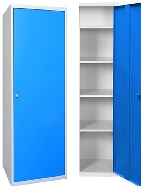
Armoire pratique et robuste. Construction monobloc soudée en tôle d'acier 6/10e et 8/10e pour le corps et 8/10e pour les portes. Fermeture par serrure à clé (jeu de 2 clés). 1 tablette fixe dans la partie haute de l'armoire. 3 tablettes dont 2 amovibles réglables tous les 25 mm. Oméga de renfort sur toute la hauteur de la porte. Peinture poudre époxy cuite au four à 180 degrés. Coloris : corps gris, porte bleue. Modèle 1 porte. Dims (cm) : L60 X P49 X H180. Autres coloris, nous consulter.
