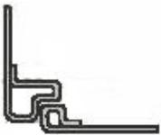
Le procédé de **profilage agrafage Seamline®** renforce la résistance des montants, équivalent à une tôle ép. 10/10<sup>ème</sup> pliée.
